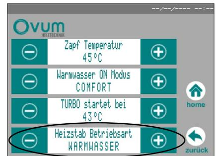
Heizstab Betriebsart auf gewünschte Einstellung setzen. (Warmwasser, Warmwasser + Heizung, Fix Ein, Aus)
